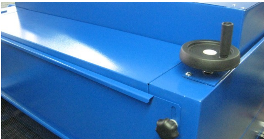
Ilustracja 10: pokrętło zmiany wysokości lampy nad pasem
