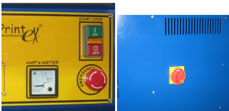
Ilustracja 4: Ilustracja 1: panel sterowniczy, widoczny przycisk E-STOP oraz WYŁĄCZNIK GŁÓWNY
